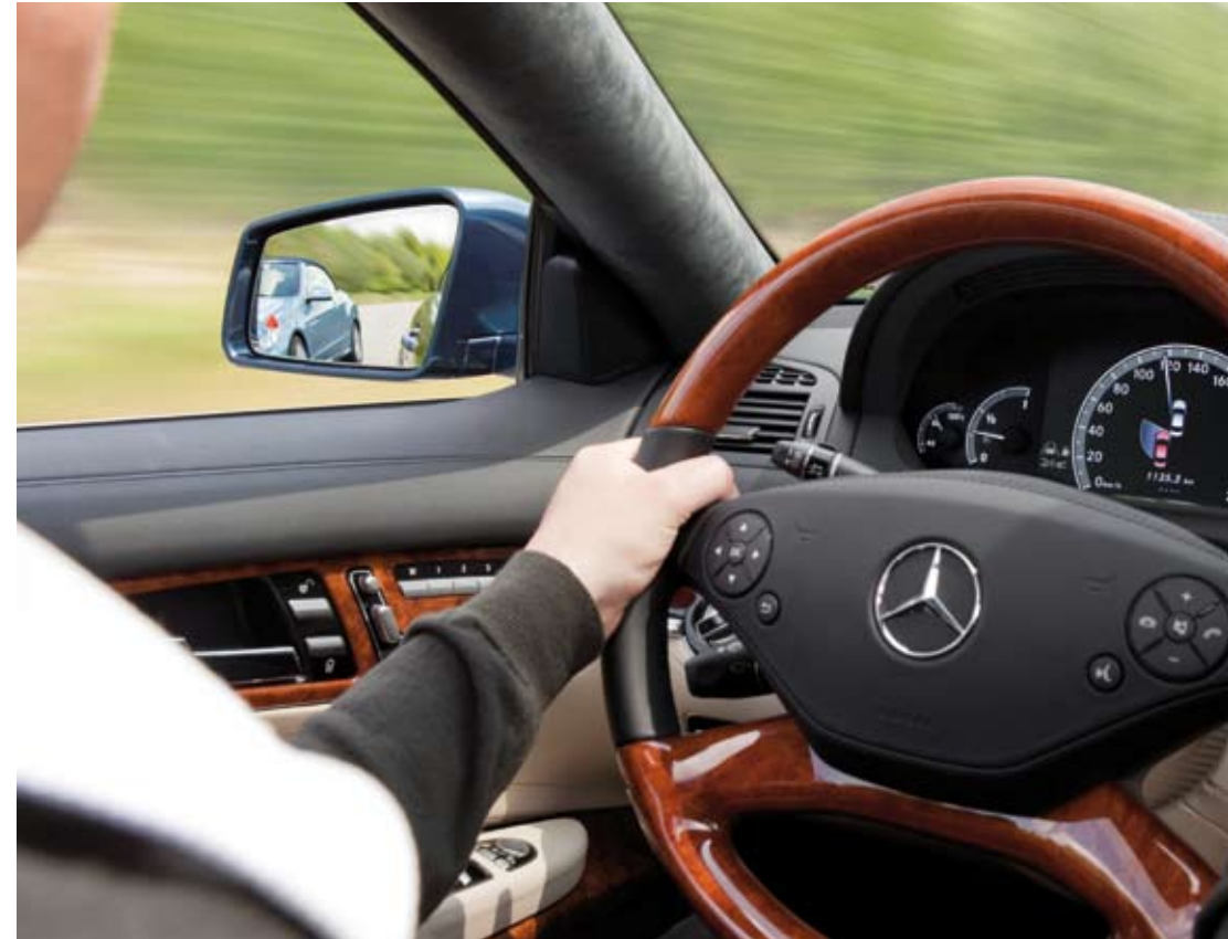
↑ Der radarbasierte Aktive Totwinkel-Assistent warnt den Autofahrer beim Spurwechsel, wenn er im toten Winkel des Außenspiegels ein anderes Fahrzeug erkennt. Beim aktiven Spurhalte-Assistenten erkennt eine Kamera an der Frontscheibe durchgezogene Fahrbahnmarkierungen und warnt, wenn das Auto unbeabsichtigt von der erkannten Fahrspur abkommt. Reagiert der Fahrer nicht, bremsst das System eines oder mehrere der Räder ab und kann so dem Wechsel oder dem Abweichen von der Fahrspur entgegenwirken.
