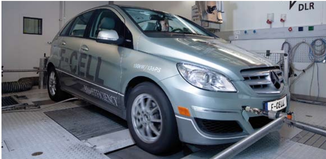
↑ Der klimatisierte Allradrollenprüfstand beim Deutschen Zentrum für Luft- und Raumfahrt (DLR)
