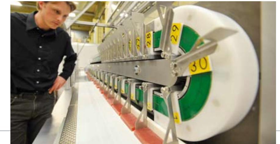
↑ Das von Bosch Packaging Technology entwickelte Intelligente Transportsystem für den flexiblen und schonenden Transport von Produkten basiert auf dem Prinzip einer Magnetschwebbahn
