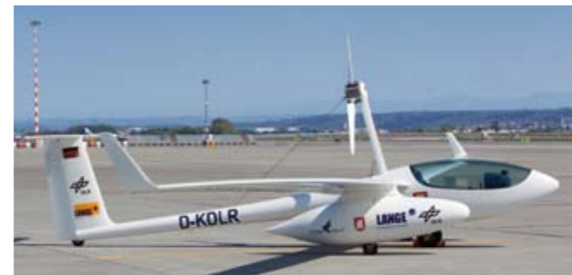
← Das Deutsche Zentrum für Luft- und Raumfahrt (DLR) entwickelt für die Zukunft: Next Generation Train und Antares DLR-H2, das weltweit erste pilotengesteuerte, mit Brennstoffzellen startfähige Flugzeug
