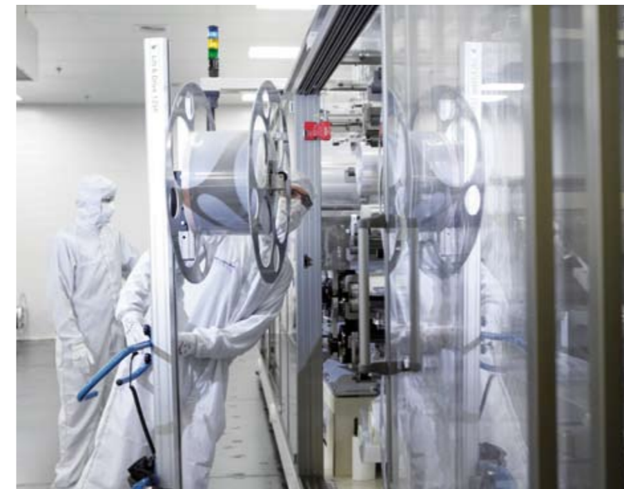
↑ Endmontage im Trocken-Raum bei European Batteries Oy, Finnland. Planung und Bau der Lithium-Ionen-Batteriefabrik wurde von der M+W Group, Stuttgart, ausgeführt.
